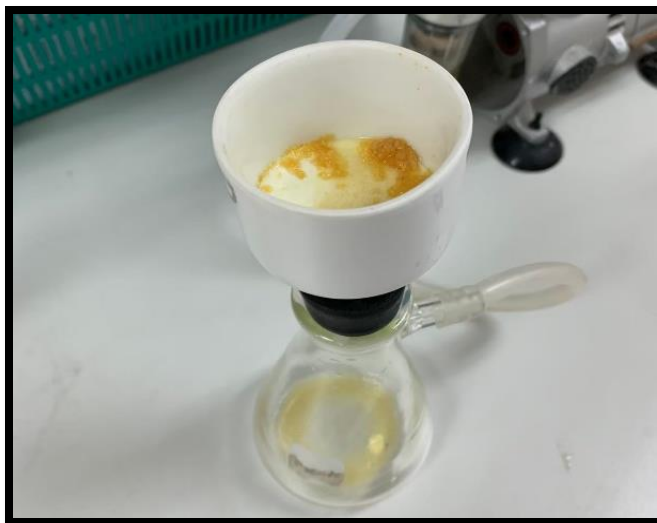
ภาพ ข-5 การกรองพืชผักที่ได้จากการย่อยแล้วด้วยชุดกรองบูชเนอร์
