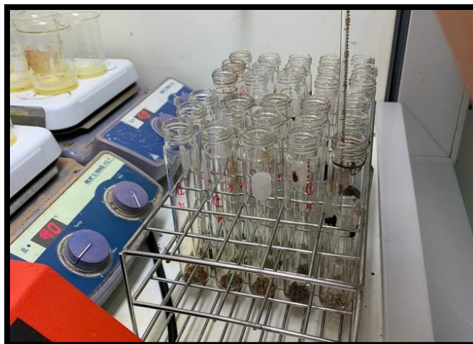
ภาพ ข-3 พืชผักที่อบแล้วและทำการเติมกรดไนตริกเข้มข้น จำนวน 1 มิลลิลิตร ทิ้งไว้ในตู้ดูดควัน
