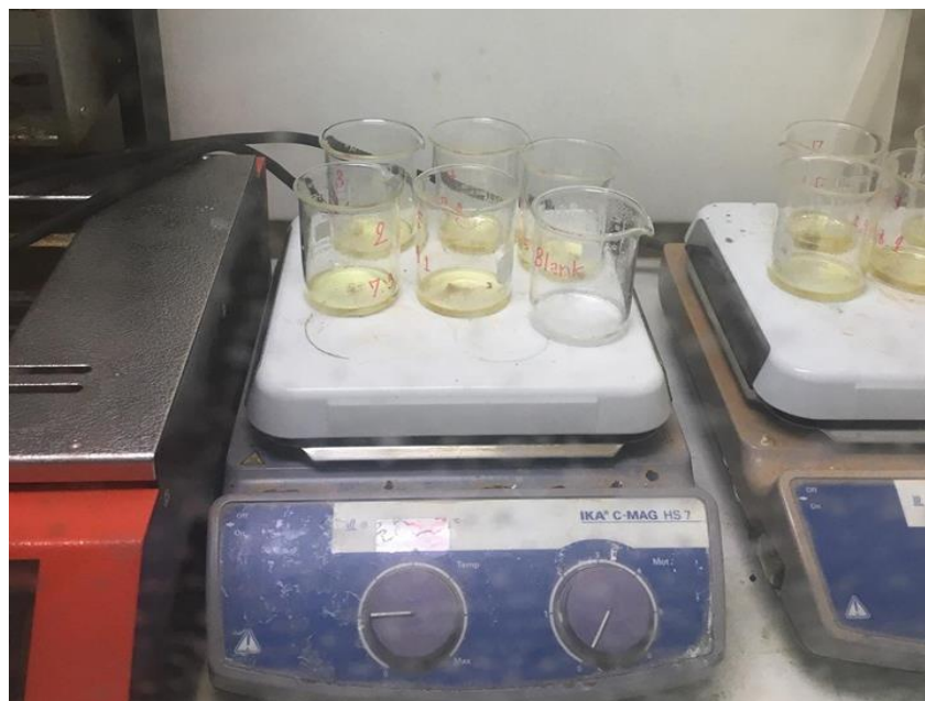
ภาพ ข-5 การนำตัวอย่างหอยหลอดมาเติมกรดไนตริก 69.0-70.0 % จากนั้นนำไปย่อยด้วยความร้อน 60 องศาเซลเซียส
