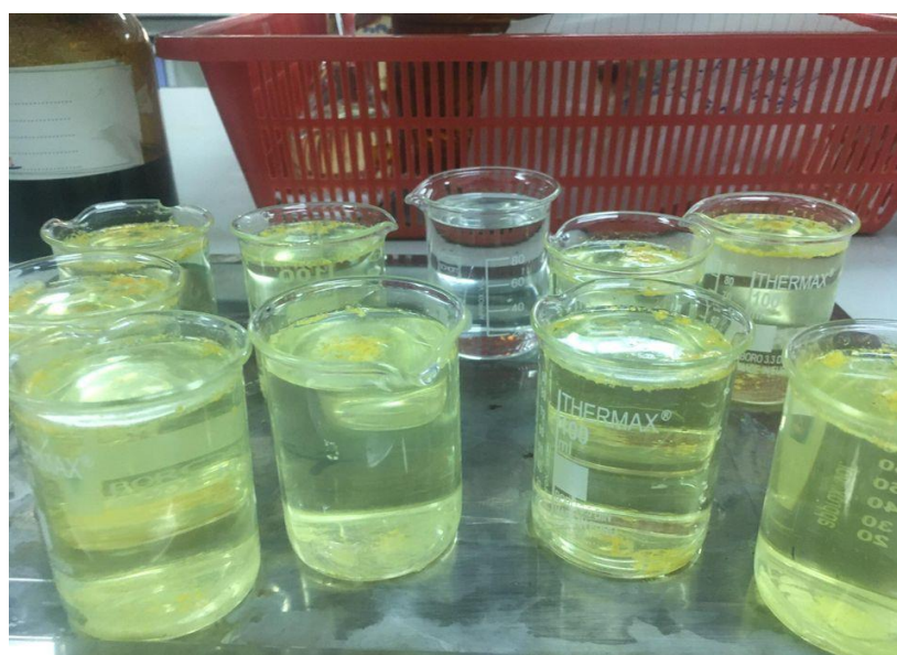
ภาพ ข-6 การทิ้งตัวอย่างให้ตกตะกอน เป็นเวลา 2 ชั่วโมง จากนั้นนำไปกรองด้วยกระดาษกรอง ขนาด 47 มิลลิเมตร
