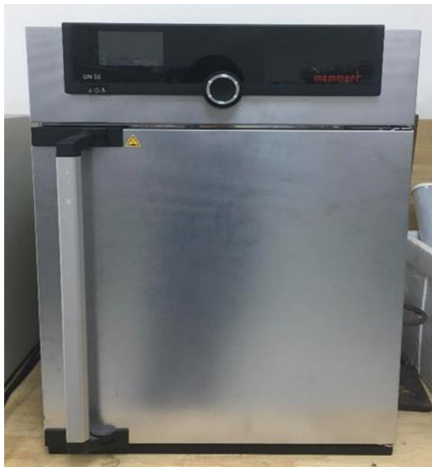
ภาพ ข-7 การอบกระดาษกรองไปอบที่อุณหภูมิ 60 องศาเซลเซียส เป็นเวลา 2 ชั่วโมง
