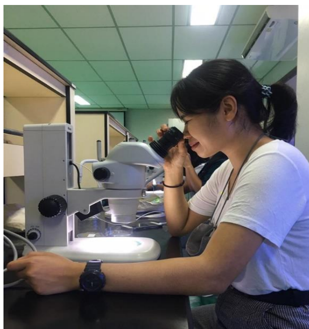
ภาพ ข-8 การส่องด้วยกล้องจุลทรรศน์เพื่อดูลักษณะและปริมาณของไมโครพลาสติก
