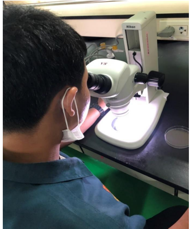
ภาพ ข-13 การนำกระดาษกรองไปส่องด้วยการส่องกล้องจุลทรรศน์สเตอริโอ
