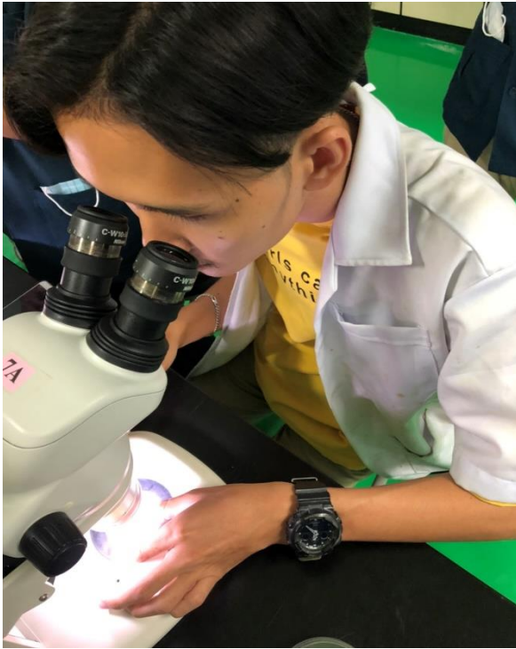
ภาพ ข-13 การนำกระดาษกรองไปส่องด้วยการส่องกล้องจุลทรรศน์สเตอริโอ
