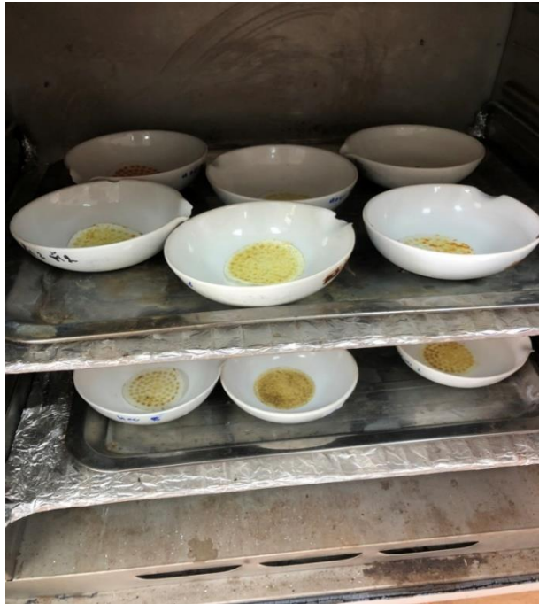
ภาพ ข-11 ส่วนที่กรองแล้วไปอบด้วยตู้อบ (Oven) ที่ 60 องศาเซลเซียสเป็นเวลา 2 ชั่วโมง
