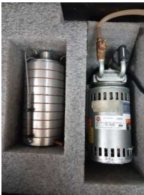
ภาพที่ 2.3 แอนเดอร์สันอิมแพ็คเตอร์ชนิด 8 ชั้น
