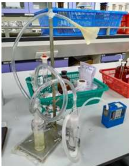
ภาพที่ 2.6 ขวดอิมพินเจอร์และปั๊มดูดอากาศ
