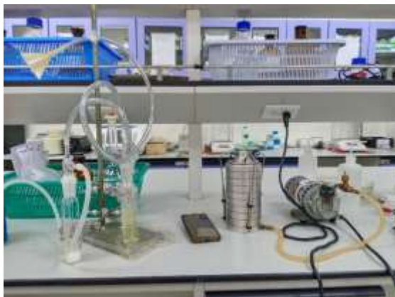
ภาพ ก-10 การเก็บตัวอย่างโดยวางเครื่อง Andersen Impactor และเครื่อง Impinger
