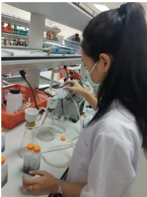
ภาพที่ ข-7 การกรองถ่านกัมมันต์ออกจากสารละลายที่ผ่านการเขย่าแล้ว
