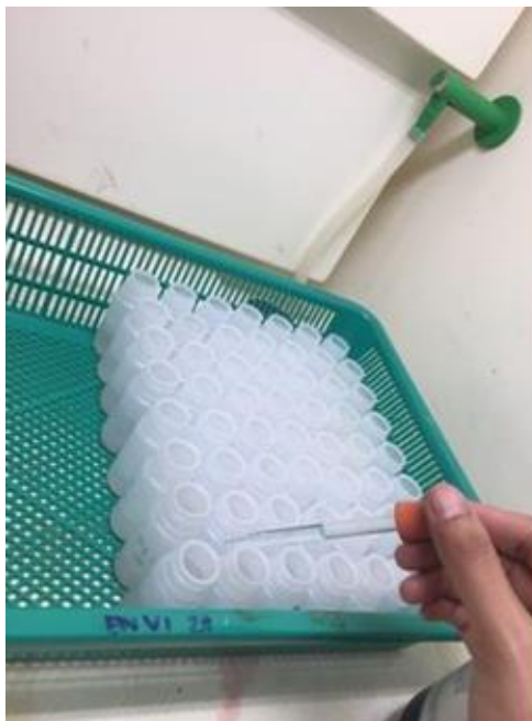
ภาพที่ ข-8 นำตัวอย่างที่ผ่านการกรองมาวัดค่า pH
