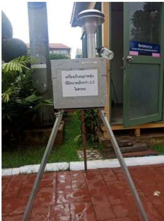
ภาพที่ ค-13 การติดตั้งเครื่องเก็บตัวอย่างภายนอกป้อมรักษาความปลอดภัย
