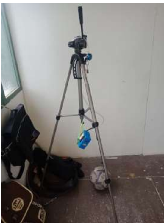
ภาพที่ ค-14 การติดตั้งเครื่องเก็บตัวอย่างภายในป้อมรักษาความปลอดภัย
