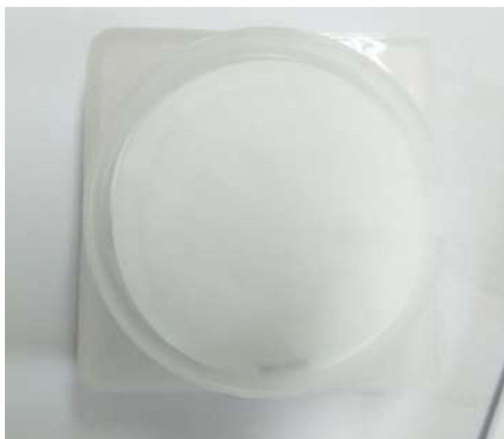
ภาพที่ ค-3 กระดาษกรองชนิด polytetra-fluoroethylene (PTFE) ขนาด 37 มิลลิเมตร
