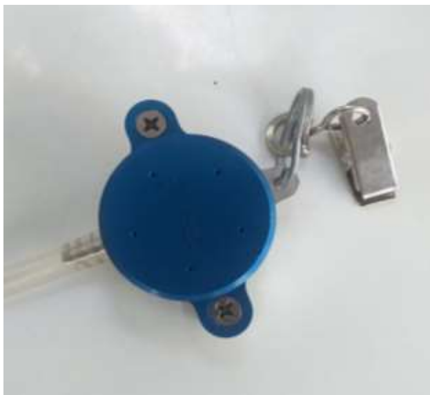
ภาพที่ ค-11 อุปกรณ์คัดแยกฝุ่นที่มีขนาดเล็กกว่า 2.5 ไมครอน
