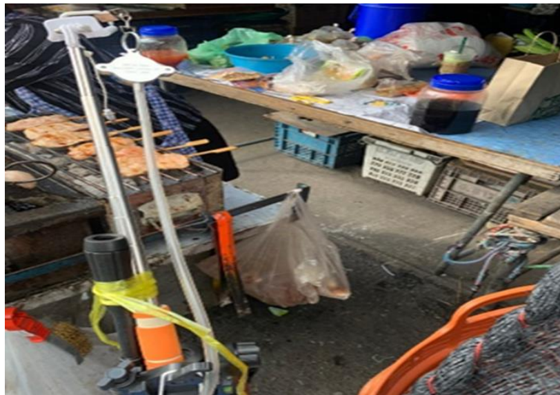
ภาพที่ จ.2 ดูดอากาศจากเตาปิ้งย่างที่ไม่ใช้ระบบดูดควัน
