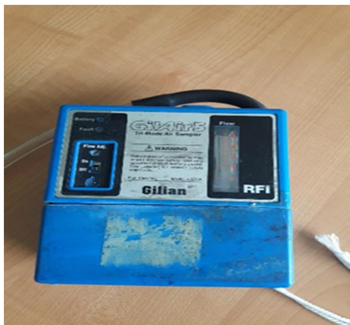
ภาพที่ ง.7 เครื่องปั๊มดูดอากาศ
