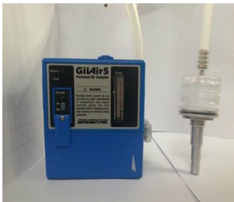
ภาพที่ ง-1 เครื่องปั๊มดูดอากาศและไซโคลน (Air Sampling Pump)
