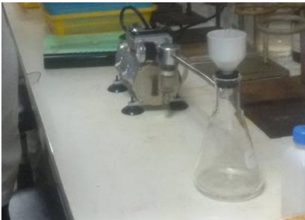
ภาพที่ จ-11 การกรองน้ำตัวอย่างเพื่อนำไประเหยหาค่าของแข็งละลายน้ำทั้งหมด
