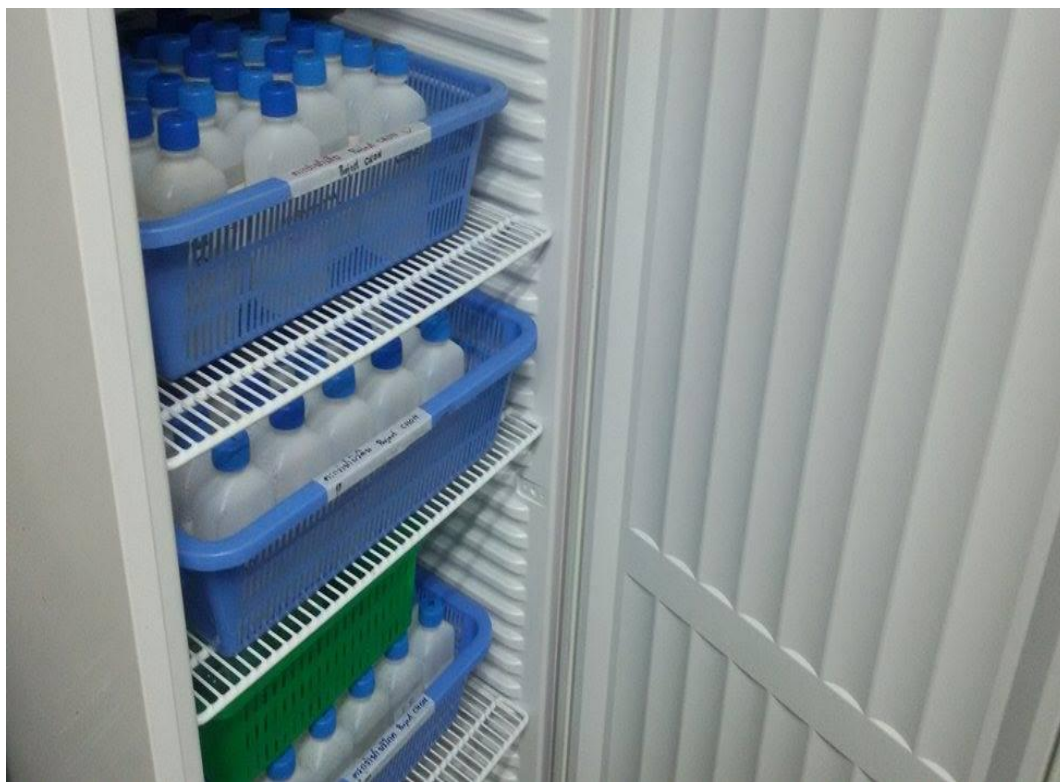
ภาพที่ จ-7 เก็บน้ำตัวอย่างไว้ที่อุณหภูมิ 4-5 องศาเซลเซียส
