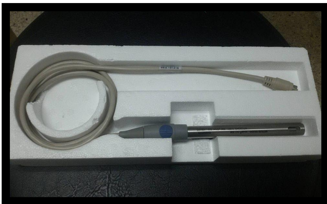
ภาพที่ 3.1 หัววัด (probe) รุ่น InLab 738
