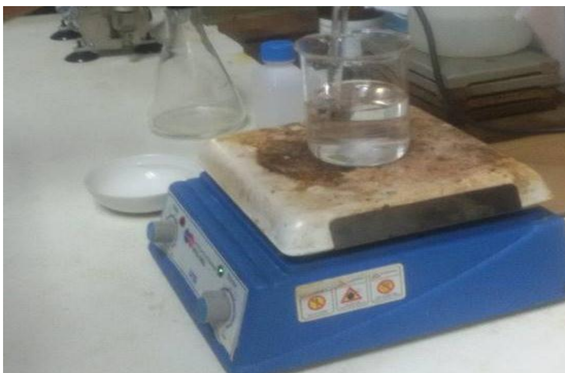
ภาพที่ จ-10 ทำการคนตัวอย่างน้ำก่อนที่จะปิเปตน้ำตัวอย่าง
