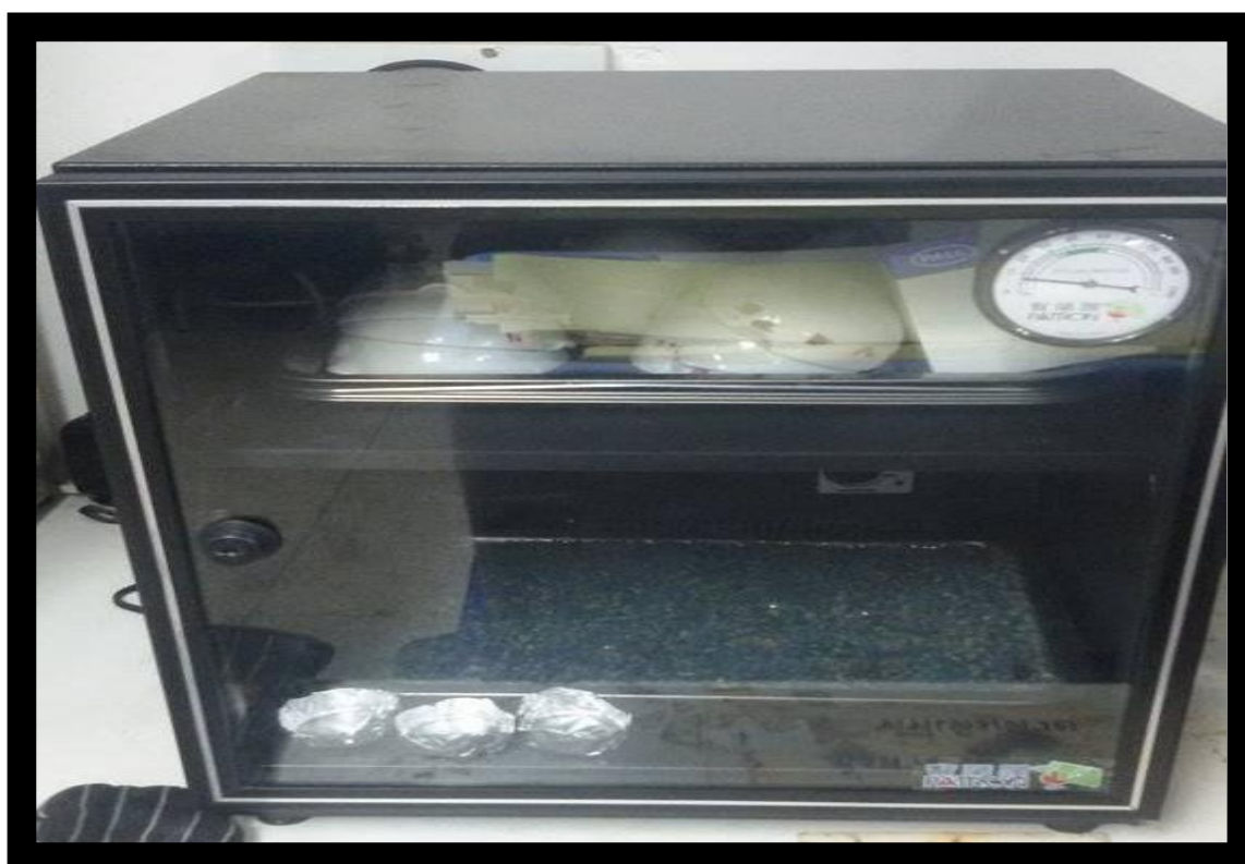
ภาพที่ 3.7 ตู้ดูดความชื้น
