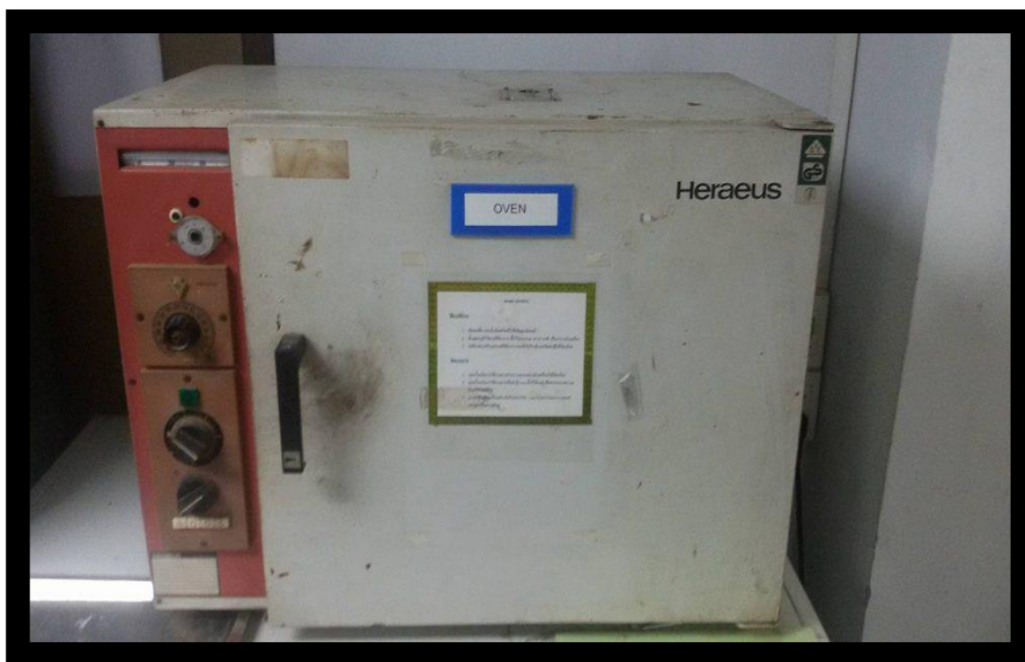
ภาพที่ 3.6 ตู้อบ ที่มีเครื่องควบคุมอุณหภูมิ 105 องศาเซลเซียส
